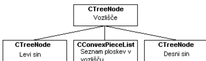
Slika 11 : Struktura drevesnega vozlišča. Vozlišče ima levega in desnega sina ter seznam ploskev v vozlišču.
